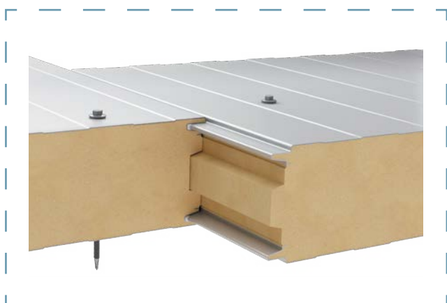
Schéma napojení panelů
