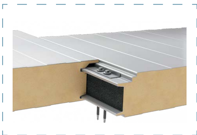
Schéma napojení panelů
