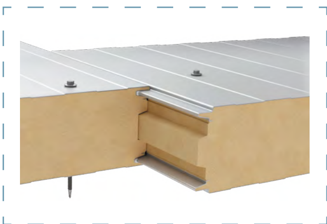
Schéma napojení panelů
