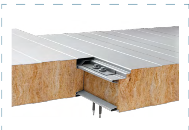
Schéma napojení panelů
