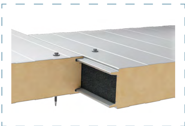
Schéma napojení panelů
